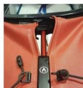
Um die Kederschiene zu schliessen, drücken Sie den Süllrand so weit wie möglich nach vorne und führen Sie die Kederleisten parallel zusammen.
